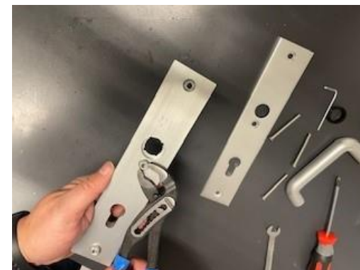
5. Draai de draadnokken uit het buitenschild (met steeksleutel 10 of waterpomptang)
