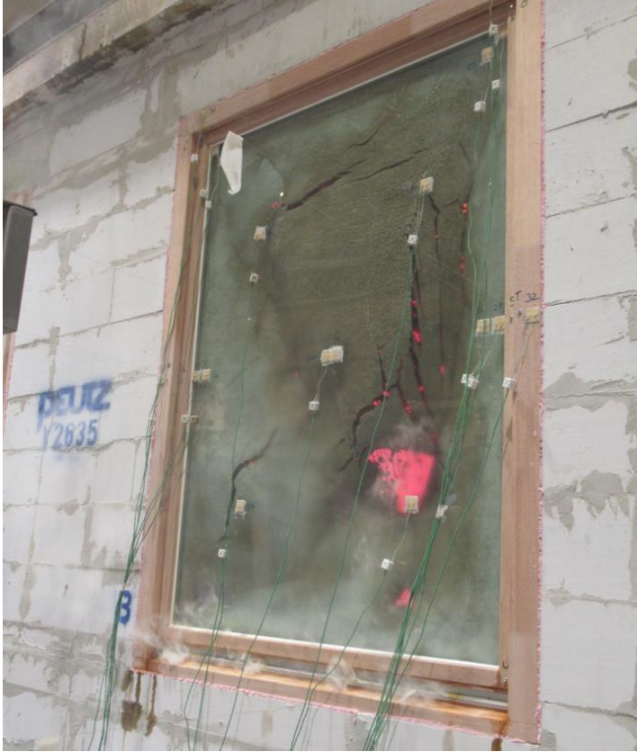
Foto 4: Merk B: 31 minuten, einde test, buitenblad bezwijkt
