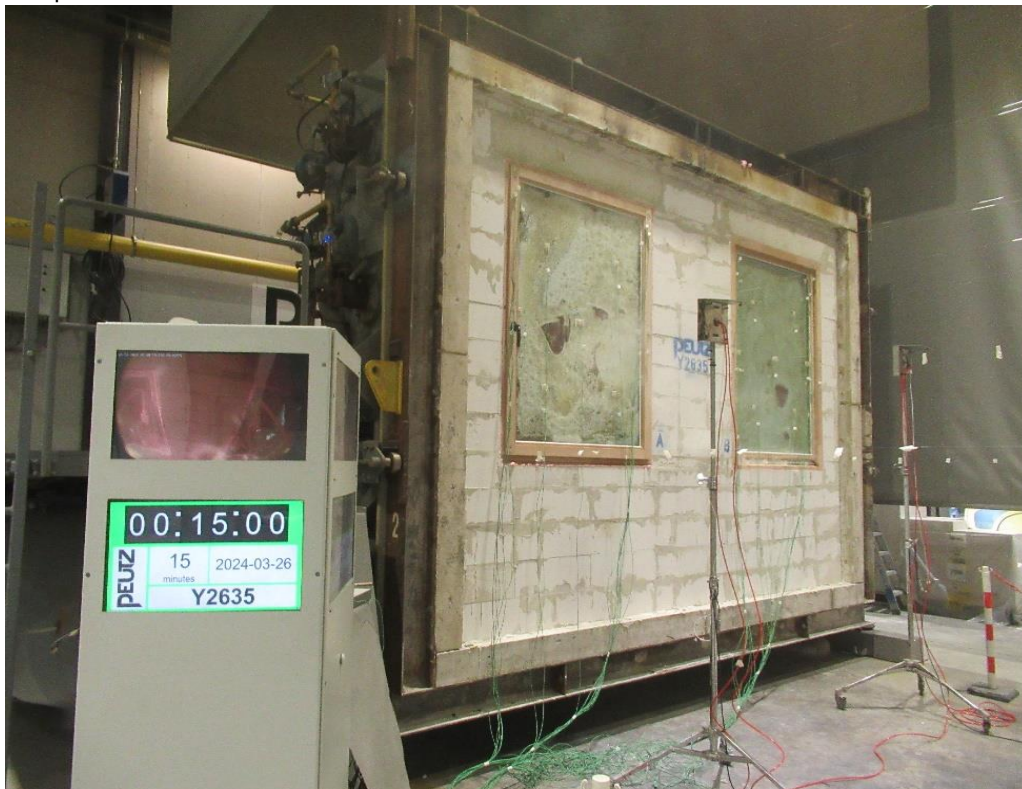
Foto 2: beproeving bij 15 minuten, beide ruiten brandwerend glasblad opgeschuimd, hotspots zichtbaar
