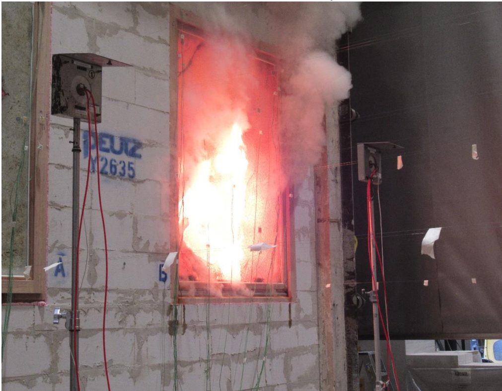
Foto 4: Merk B: 31 minuten, einde test, buitenblad bezwijkt
